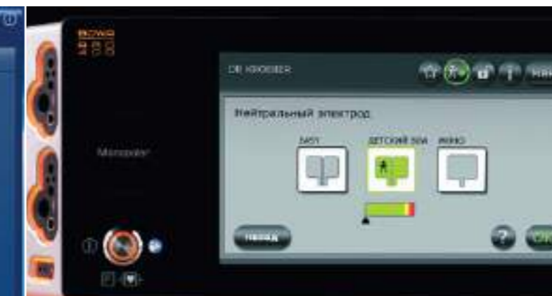
Контроль нейтрального электрода непрерывно информирует пользователя о статусе. Например, настройки детского электрода с ограничением мощности (макс. 50 Вт)
